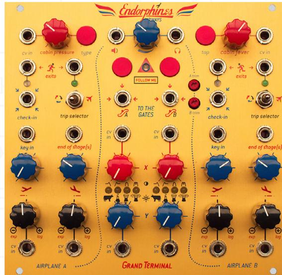
Variante ohne Hold, sowie einen Loop-Modus, welcher die Hüllkurve zum LFO umfunktioniert. Die Parameter Attack und Release lassen sich dabei jederzeit per CV modulieren und per Gate neu triggern. Auch praktisch: Geht der virtuelle Flieger vom Steigen ins Landen über oder umgekehrt, gibt ein „end of stage“-Ausgang einen kurzen Trigger aus.
