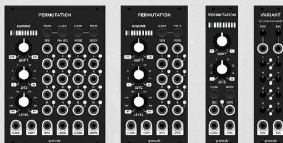
6hp-Version verzichtet komplett auf die Ausgänge der einzelnen Schritte und bietet neben CLOCK nur einen einzigen Modulations Eingang, welcher wahlweise auf SHIFT, BITS oder LEVEL gemappt werden kann. Die Grundfunktionalität ist jedoch bei allen drei Versionen identisch. Ebenfalls erhältlich ist Modul namens ein VARIANT Expander, welches die Möglichkeit bietet, die ausgegebenen Steuerspannungen einzeln zu modulieren.
